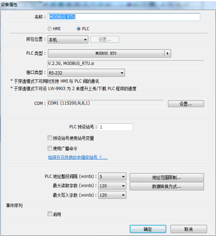
图 5. 维纶触摸屏通讯接口定义
