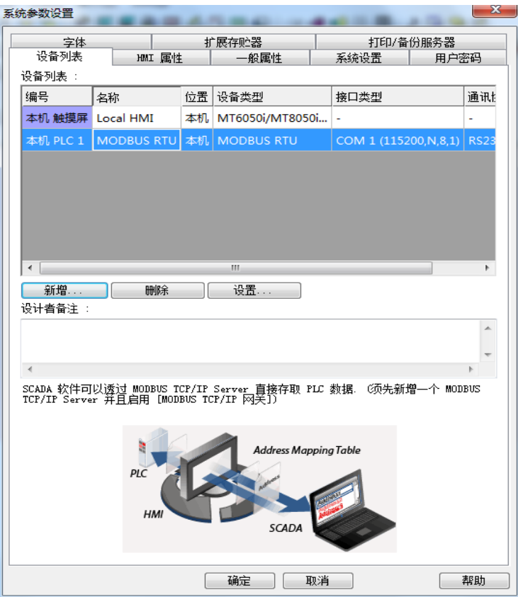
图 4. 维纶触摸屏系统参数设定
